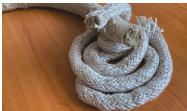
Bourrelet coupe-feu conçu avec des fibres techniques recy- clés
