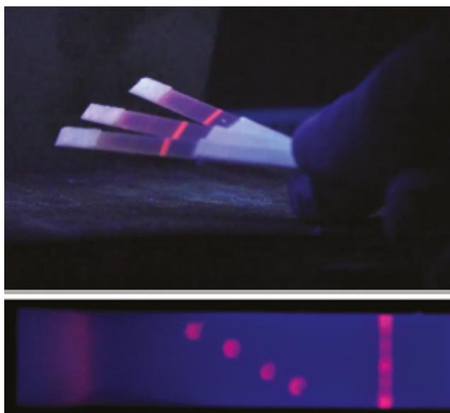
Bandelettes hyper-sensibles utilisant les nanoparticules luminescentes de LumediX sous éclairage UV
