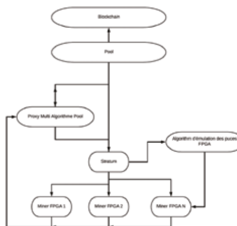
Schématisme de l'architecture de la nouvelle génération de serveurs de minage de crypto-monnaies pluri-blockchains plus performants
