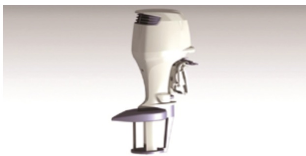
Vue d'artiste d'un ensemble hors-bord thermique équipé du rotor adv tech en substitution de l'hélice
