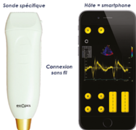
Représentation du produit développé par E-Scopics à l'issue du projet DEUS, constitué d'une sonde d'imagerie générale compatibles avec les examens d'urgence, connectée via lien sans fil à un hôte de pilotage et de visualisation de type smartphone.
